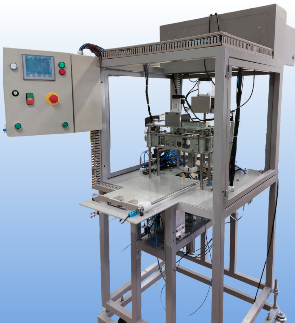
Máquina para automação de revestimento de estojos de joias
